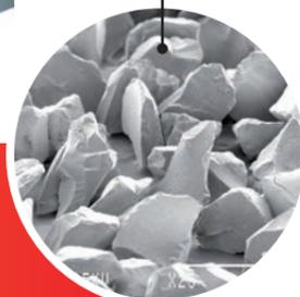
Konventionelles keramisches Schleifkorn ist unregelmäßig und „blockig“ in seiner Form. Das Metall wird damit regelrecht durchpflügt, die Hitze verbleibt im Werkstück, und es entstehen unerwünschte Begleiteffekte, wie etwa das Polieren des Metalls.
