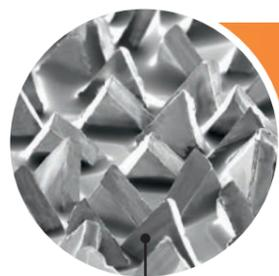
Unter dem Mikroskop lassen sich die dreieckig geformten keramischen Schleifkörner gut erkennen. Sie sind präzise geformt und einheitlich groß. Während des Schleifvorgangs splintern Bruchstücke ab und es entstehen neue scharfe Spitzen und Kanten.
